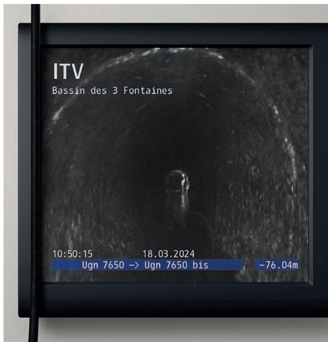
Écran de contrôle d'une inspection télévisé
